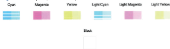
Figura 9-2 Ejemplo de bloques de color con defectos
