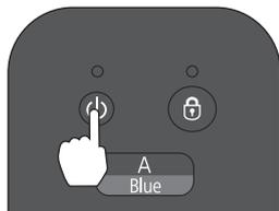
El indicador de alimentación parpadea en azul claro durante la puesta en marcha. La puesta en marcha se habrá completado cuando el indicador de alimentación deje de parpadear y se ilumine permanentemente en azul claro.
