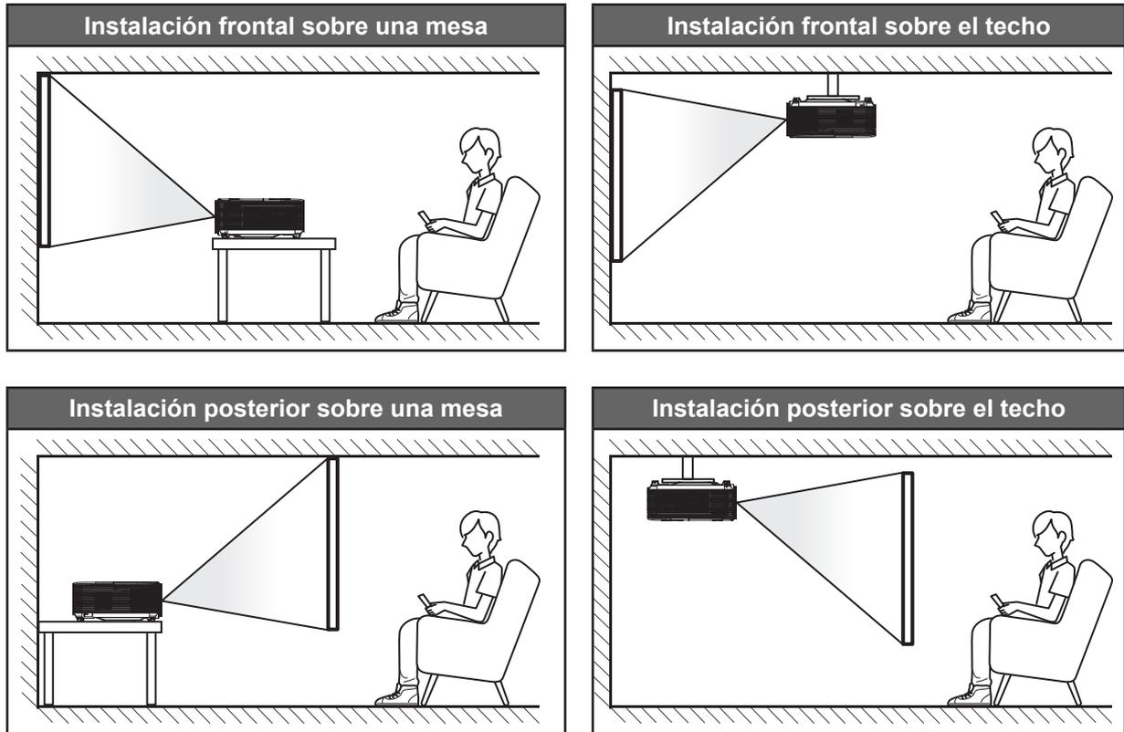
El proyector se debe colocar plano sobre una superficie y con un ángulo de 90 grados o perpendicular a la pantalla.
