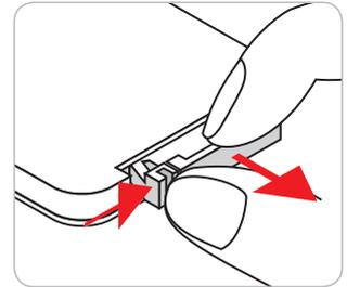
2. Coloque una pila nueva en el compartimiento. Extraiga la pila usada y coloque una nueva (CR2025). Asegúrese de que el lado con un signo "+" quede hacia arriba.
