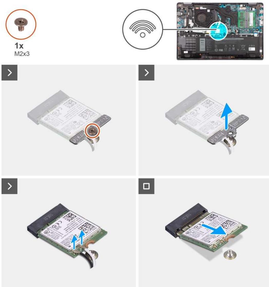
**Ilustración 14. Extracción de la tarjeta inalámbrica**
