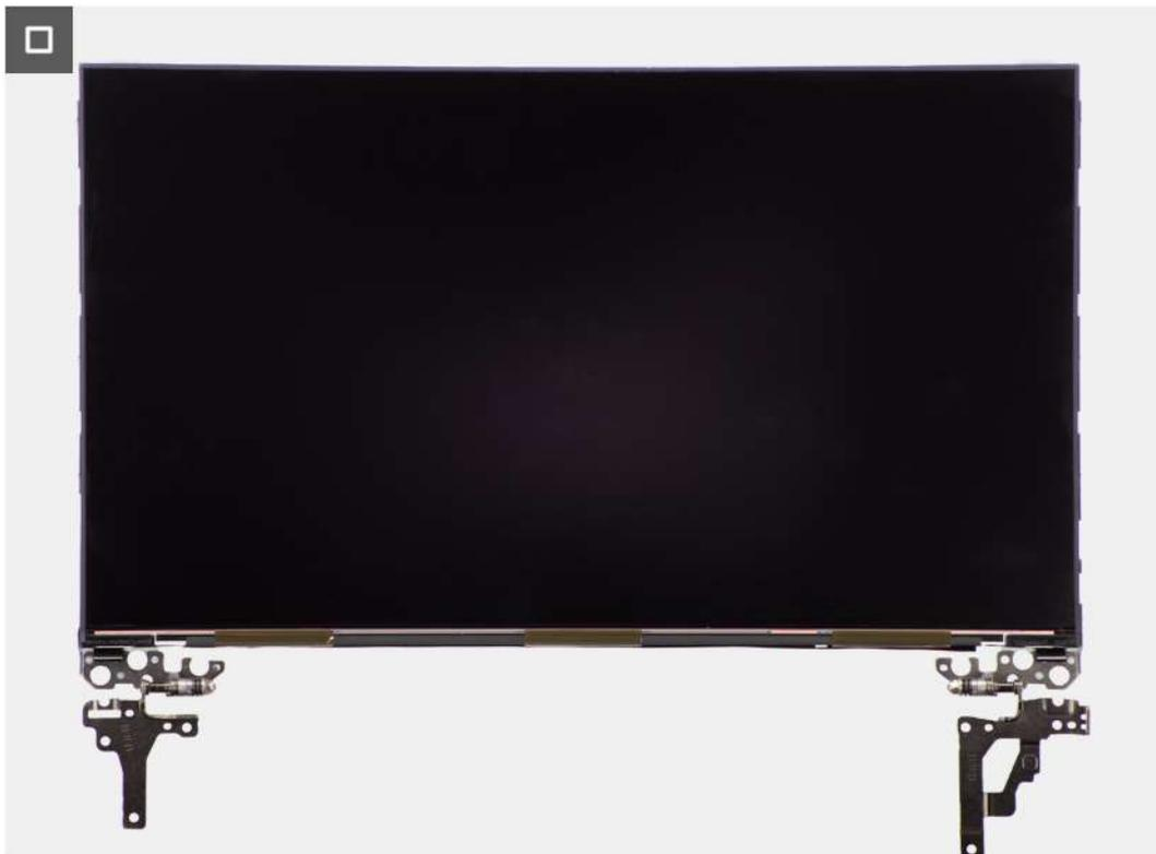
**Ilustración 60. Extracción del panel de pantalla**
