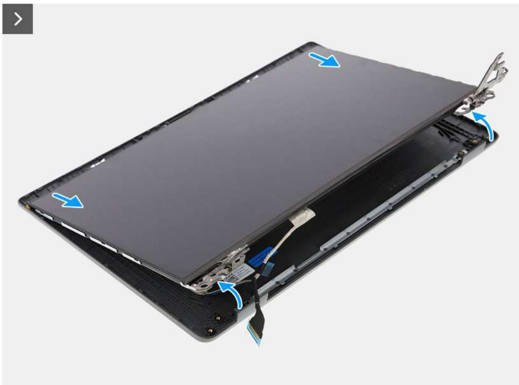
Ilustración 58. Extracción del panel de pantalla
