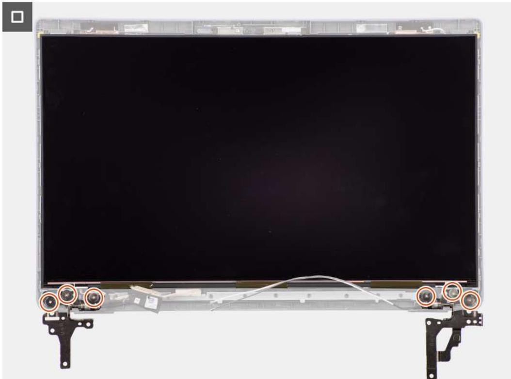
**Ilustración 65. Instalación del panel de pantalla**
