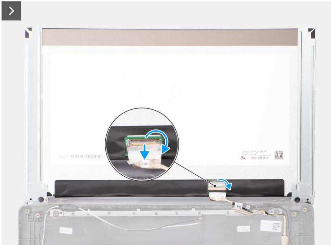
**Ilustración 59. Extracción del panel de pantalla**
