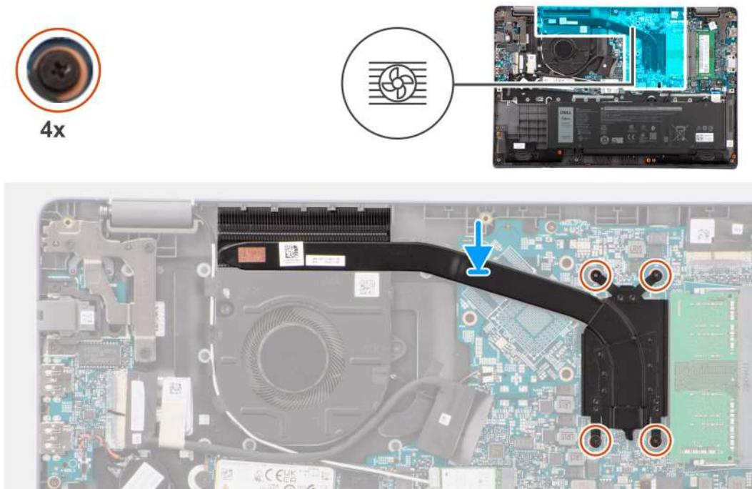
**Ilustración 30. Instalación del disipador de calor para gráficos integrados**
