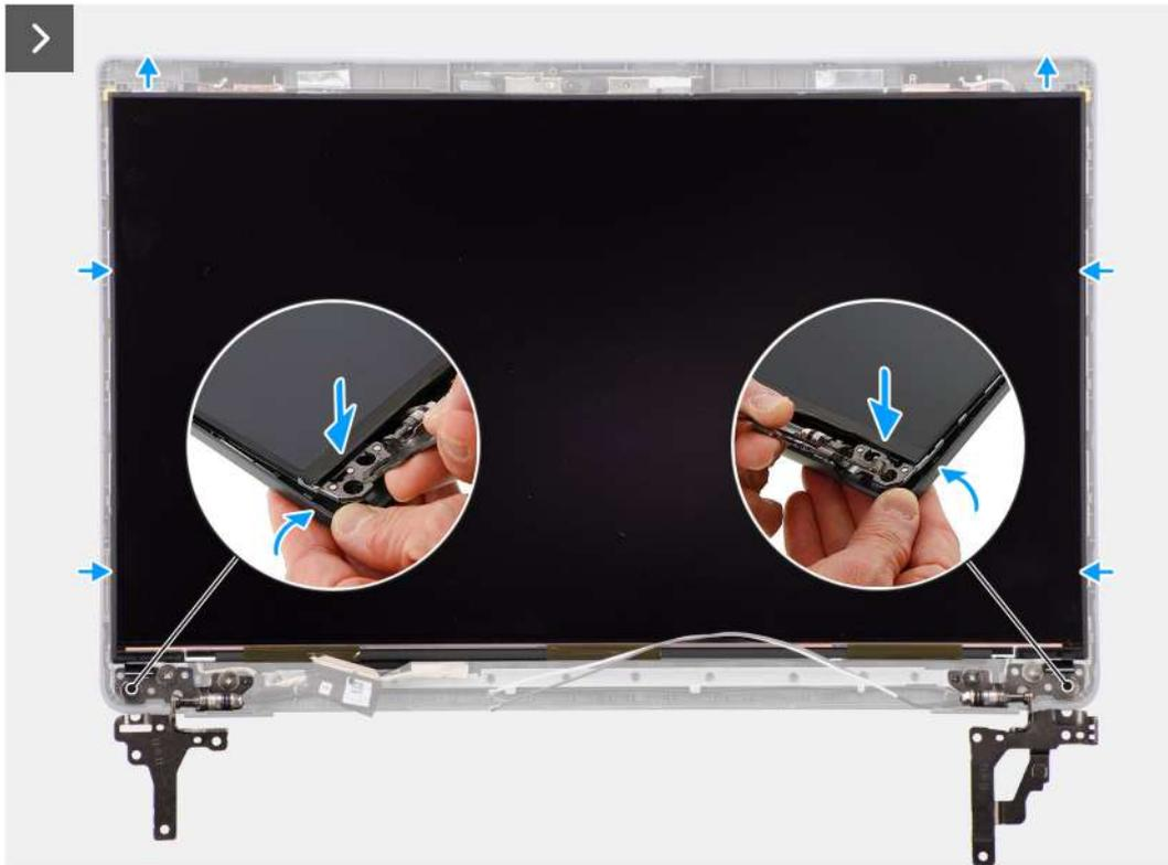
Ilustración 64. Instalación del panel de pantalla
