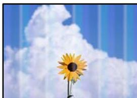
■ **Los inyectores del cabezal de impresión pueden estar obstruidos.**
