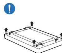
Deje el producto en posición horizontal para manejarlo como se muestra en la imagen (se puede utilizar el embalaje).
