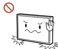
No coloque el producto en la posición que se muestra en la ilustración. El panel es frágil y se puede estropear.
