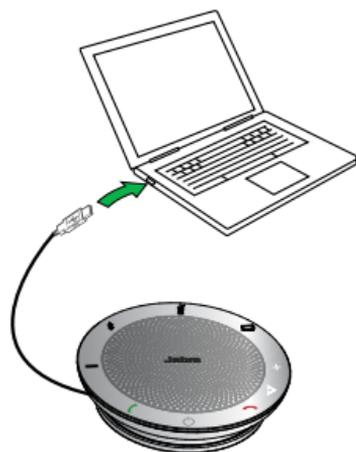
Conecte el cable USB de su Jabra Speak 510 a cualquier puerto USB disponible en su PC para cargar la batería. La luz de la batería se enciende en color rojo durante la carga, y verde, durante un minuto, cuando está totalmente cargada.
