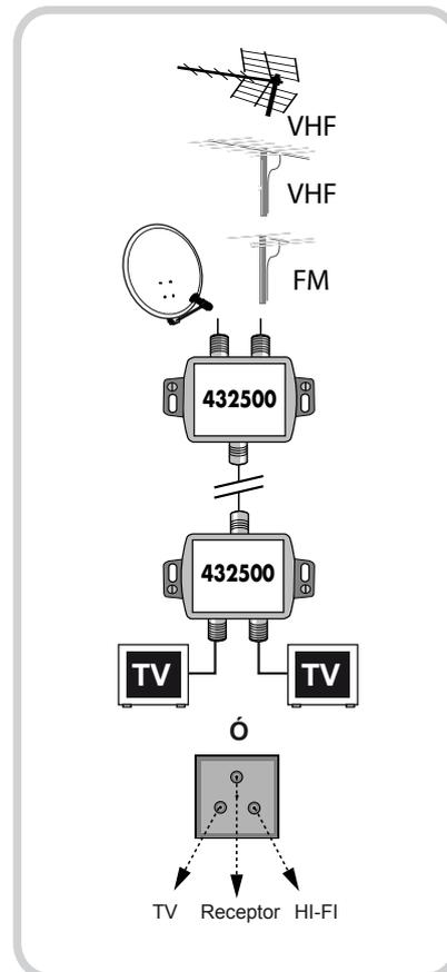
Permite acoplar una parabólica a un sistema de recepción TDT, utilizando un sólo cable de bajada.
