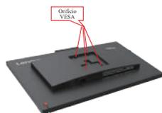
Paso 5: Acople la pantalla LCD a la pared siguiendo las instrucciones del kit de instalación en pared.
