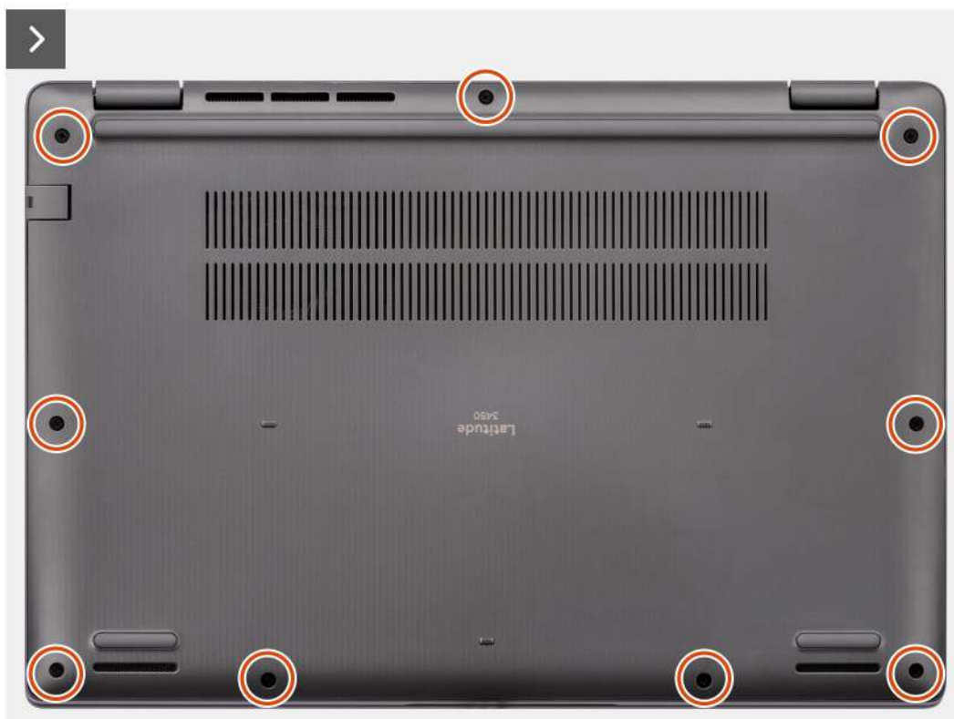
Ilustración 9. Extracción de la cubierta de la base
