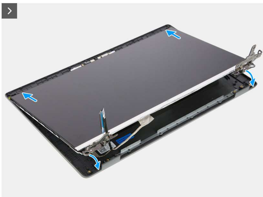
Ilustración 61. Instalación del panel de pantalla
