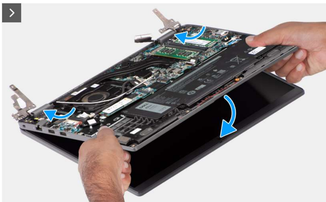
Ilustración 49. Extracción del ensamblaje de la pantalla
