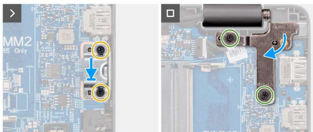
Ilustración 44. Instalación de la tarjeta madre
