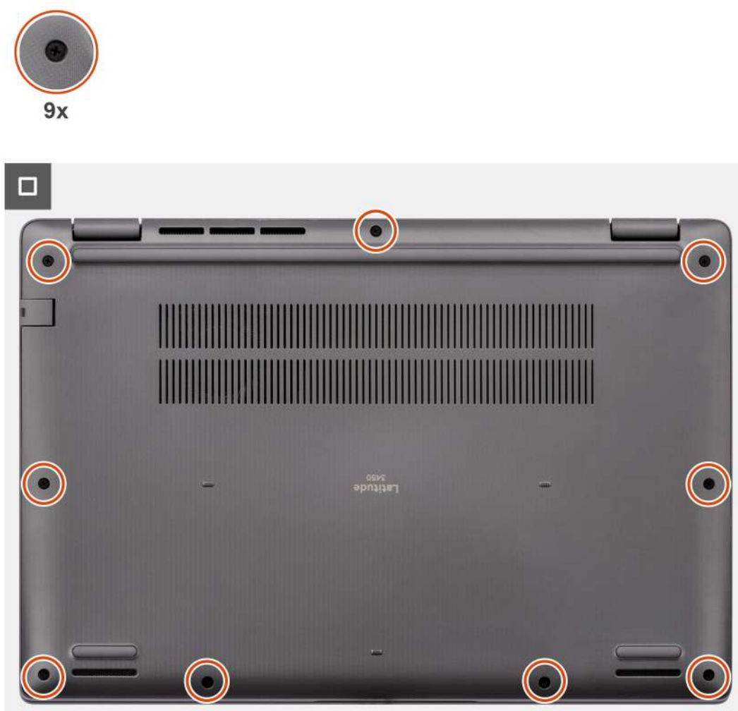
Ilustración 12. Instalación de la cubierta de la base
