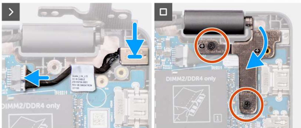
Ilustración 28. Instalación del puerto del adaptador de alimentación
