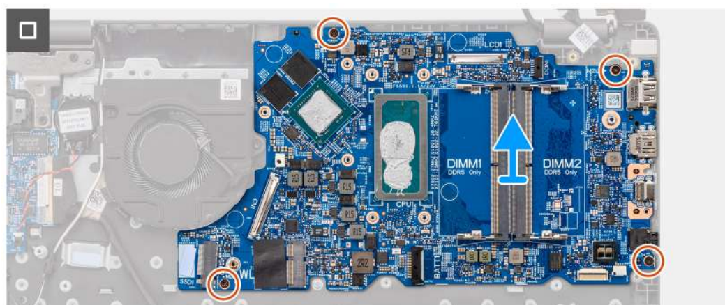
Ilustración 42. Extracción de la tarjeta madre
