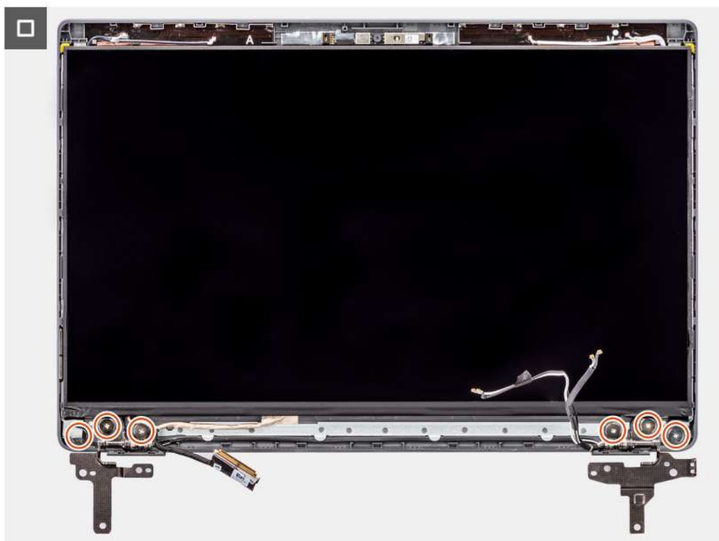
Ilustración 63. Instalación del panel de pantalla
