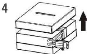
Retire la cubierta superior de la caja de las baterías e instale las baterías en su interior
