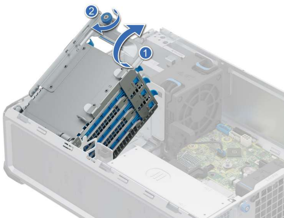
Ilustración 22. Instalación de un portaunidades
