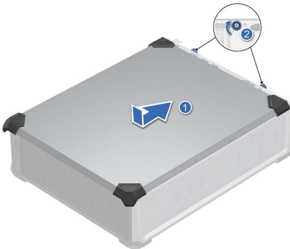
Ilustración 13. Instalación de la cubierta del sistema
