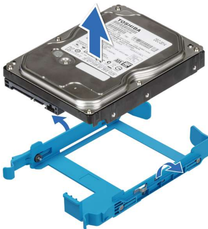
Ilustración 24. Extracción de una unidad del portaunidades
