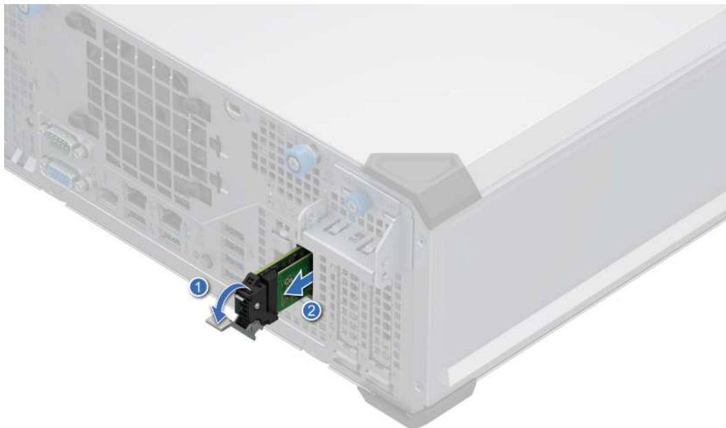
Ilustración 51. Extracción del portaunidades de tarjeta BOSS-N1
