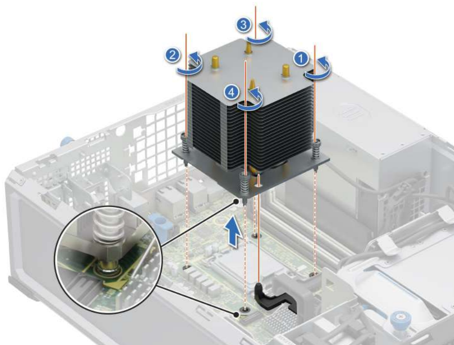
Ilustración 37. Extracción del disipador de calor
