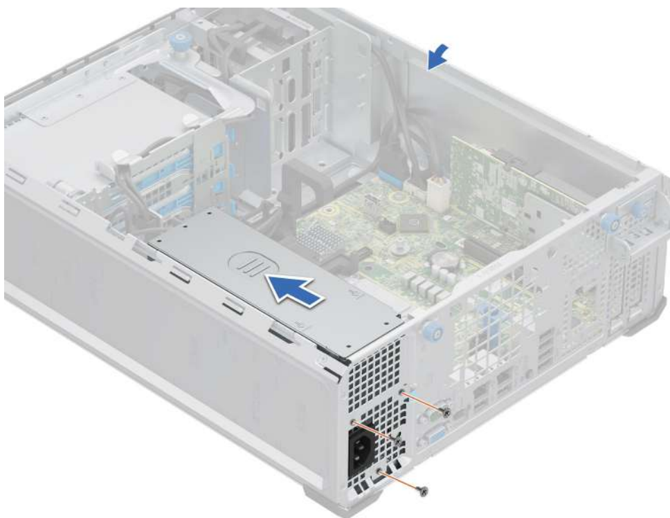
Ilustración 57. Extracción de la PSU cableada
