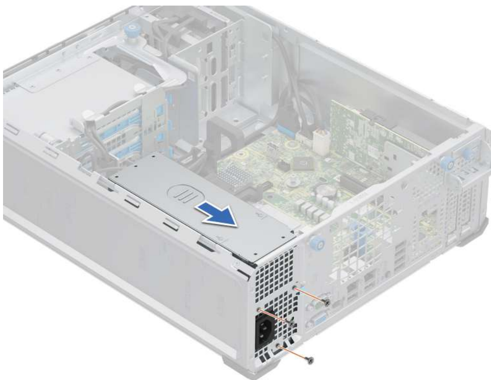
Ilustración 58. Instale la PSU cableada.
