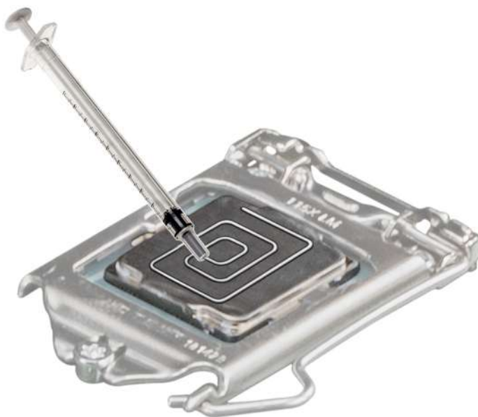
Ilustración 40. Aplicación de la pasta térmica en la parte superior del procesador
