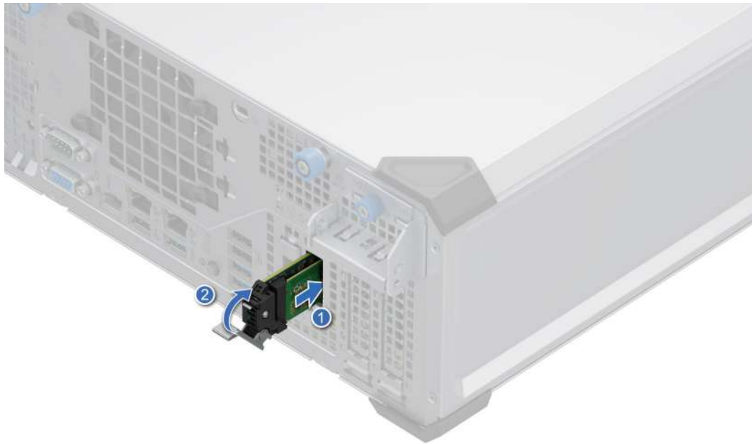
Ilustración 56. Instalación del portatarjetas de BOSS-N1
