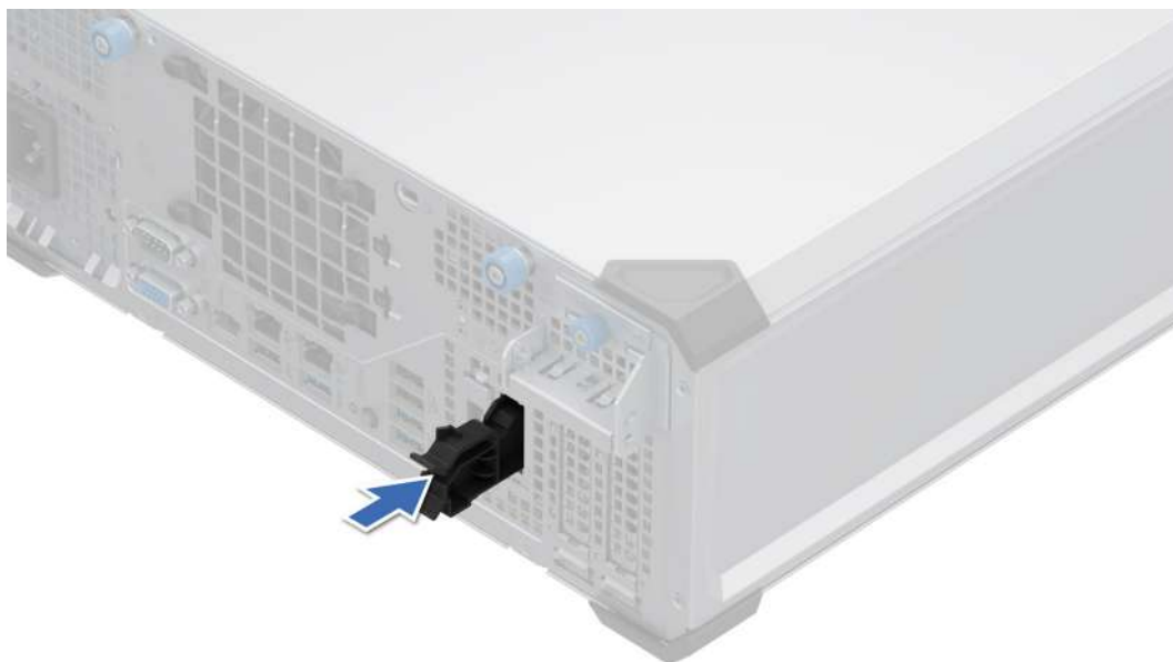
Ilustración 48. Instalación del módulo de BOSS-N1 de relleno
