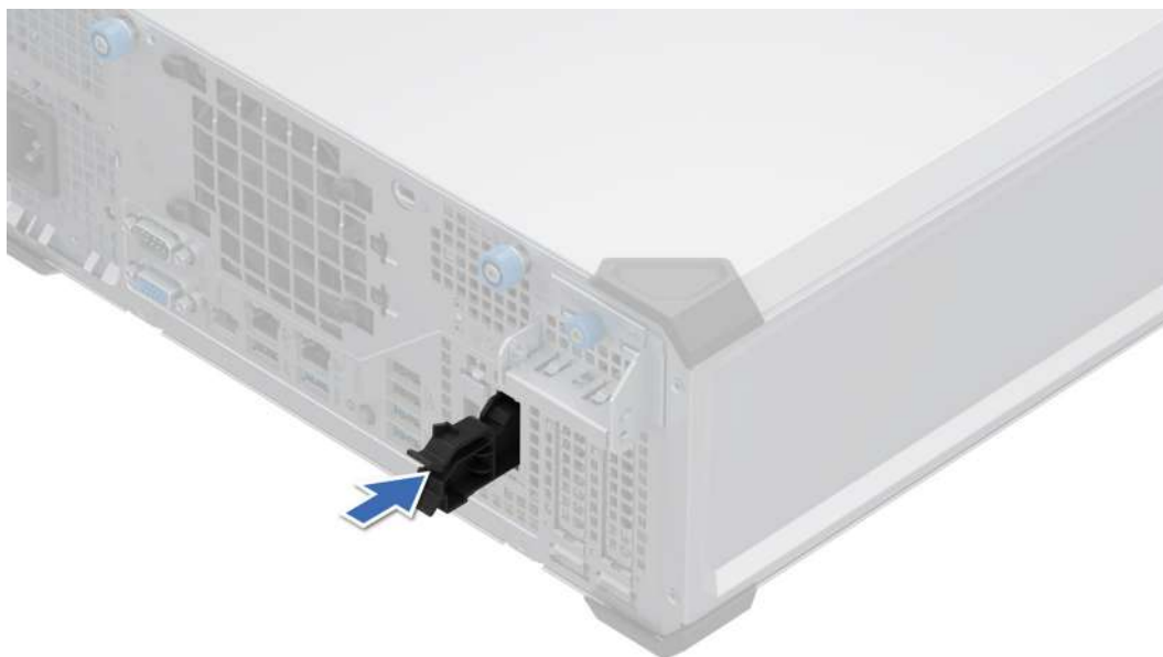
Ilustración 53. Instalación del portaunidades de tarjeta BOSS-N1 de relleno
