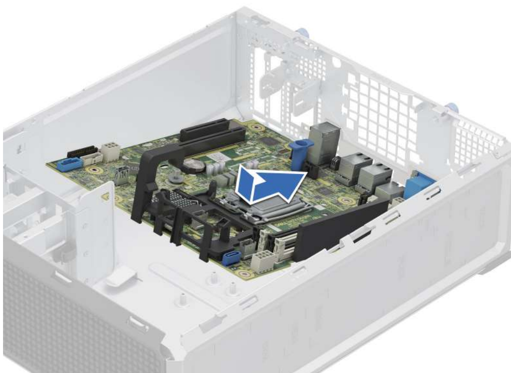
Ilustración 63. Instalación de la tarjeta madre
