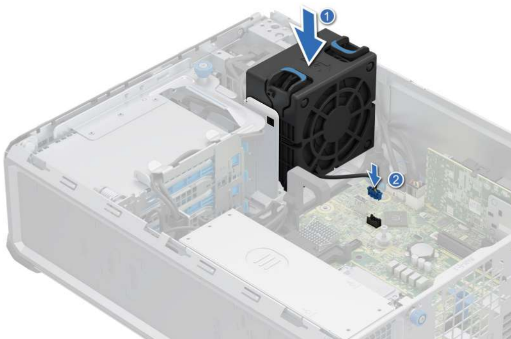
Ilustración 29. Instalación del ventilador de PCI de alto rendimiento (HPR)
