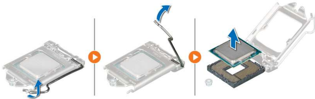
Ilustración 38. Extracción del procesador
