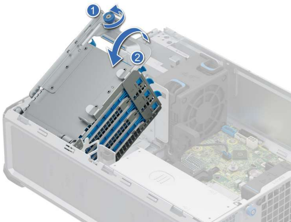
Ilustración 18. Extracción de una unidad de la caja de unidades
