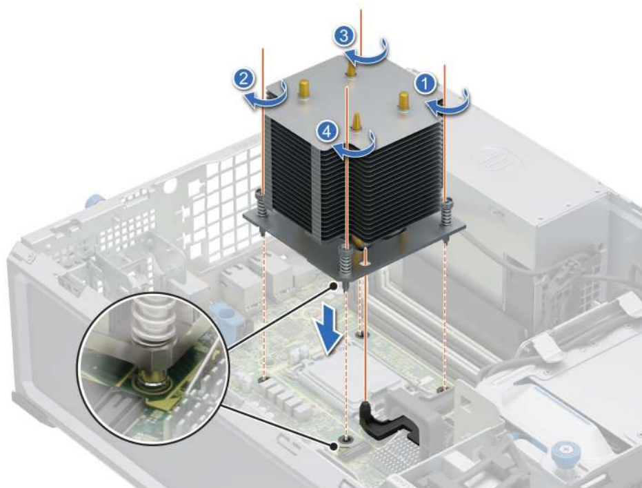
Ilustración 41. Instalación del disipador de calor
