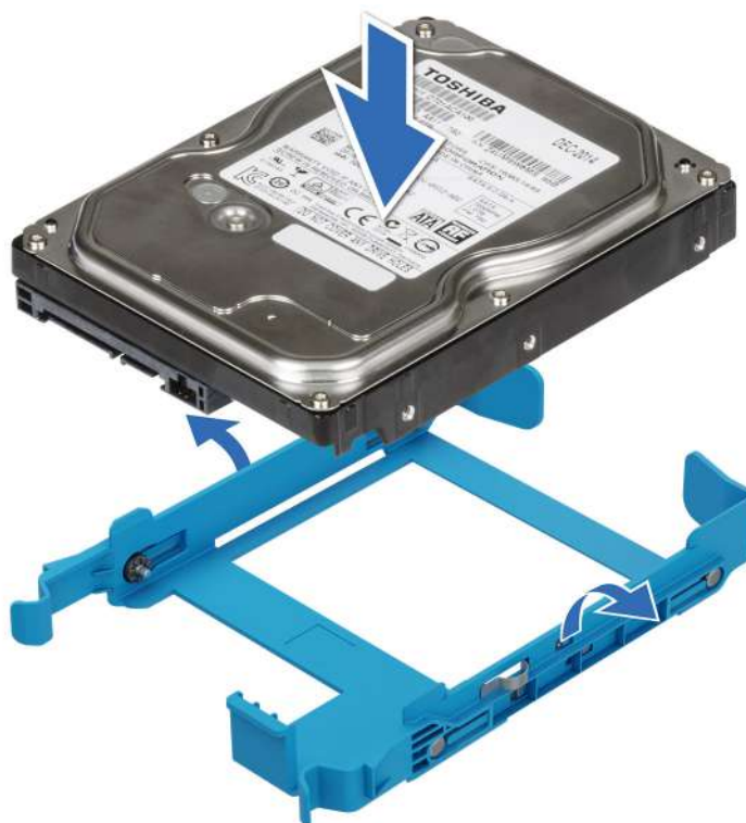
Ilustración 25. Instalación de una unidad en el portaunidades
