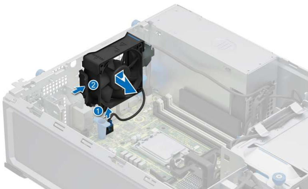
Ilustración 26. Extracción del ventilador de enfriamiento
