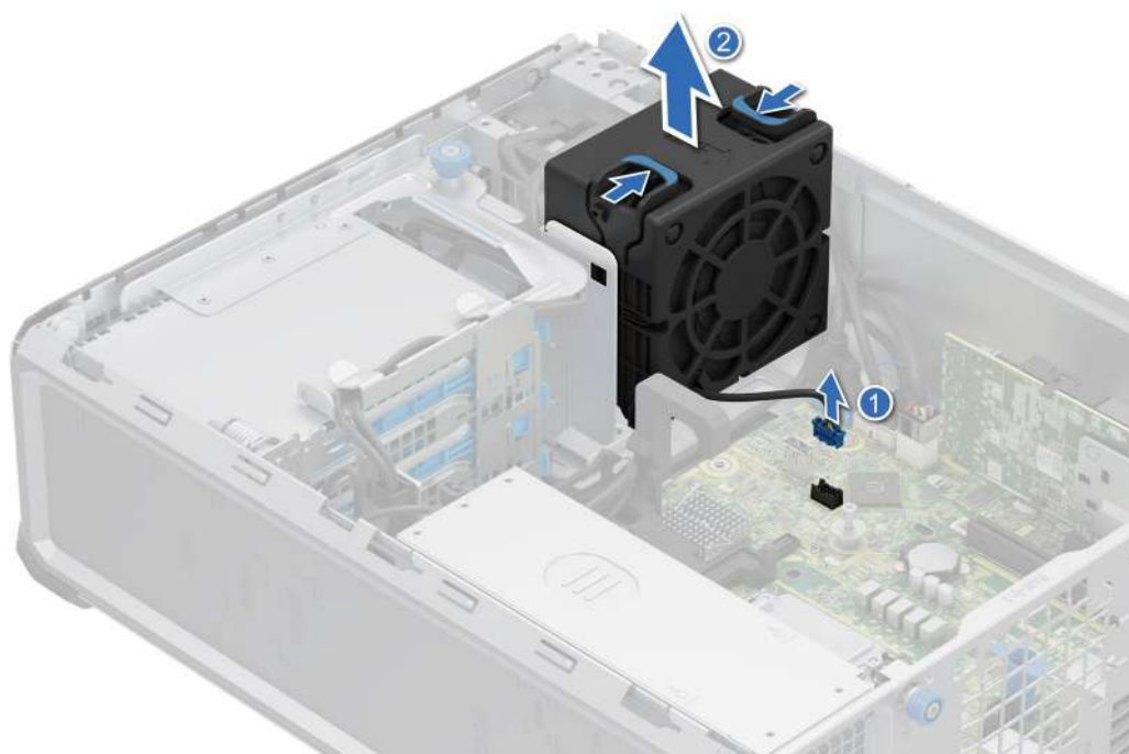
Ilustración 27. Extracción del ventilador de PCI de alto rendimiento (HPR)
