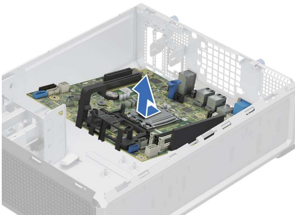
Ilustración 62. Extracción de la tarjeta madre
