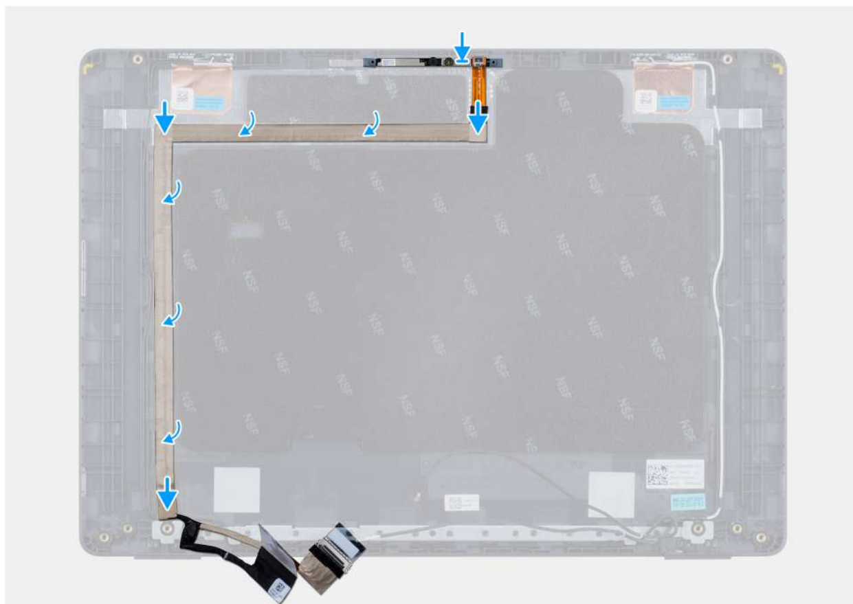
Ilustración 122. Instalación del cable eDP
