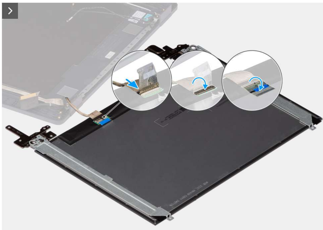
Ilustración 116. Instalación del ensamblaje del panel de pantalla
