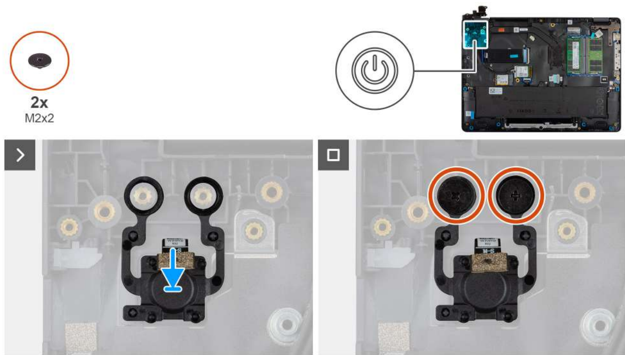
Ilustración 56. Instalación del botón de encendido con un lector de huellas digitales
