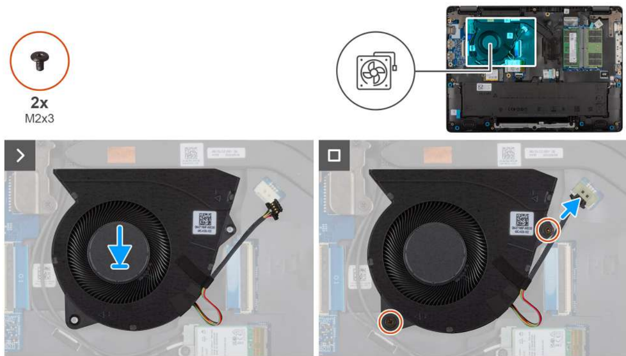
Ilustración 34. Instalación del ventilador
