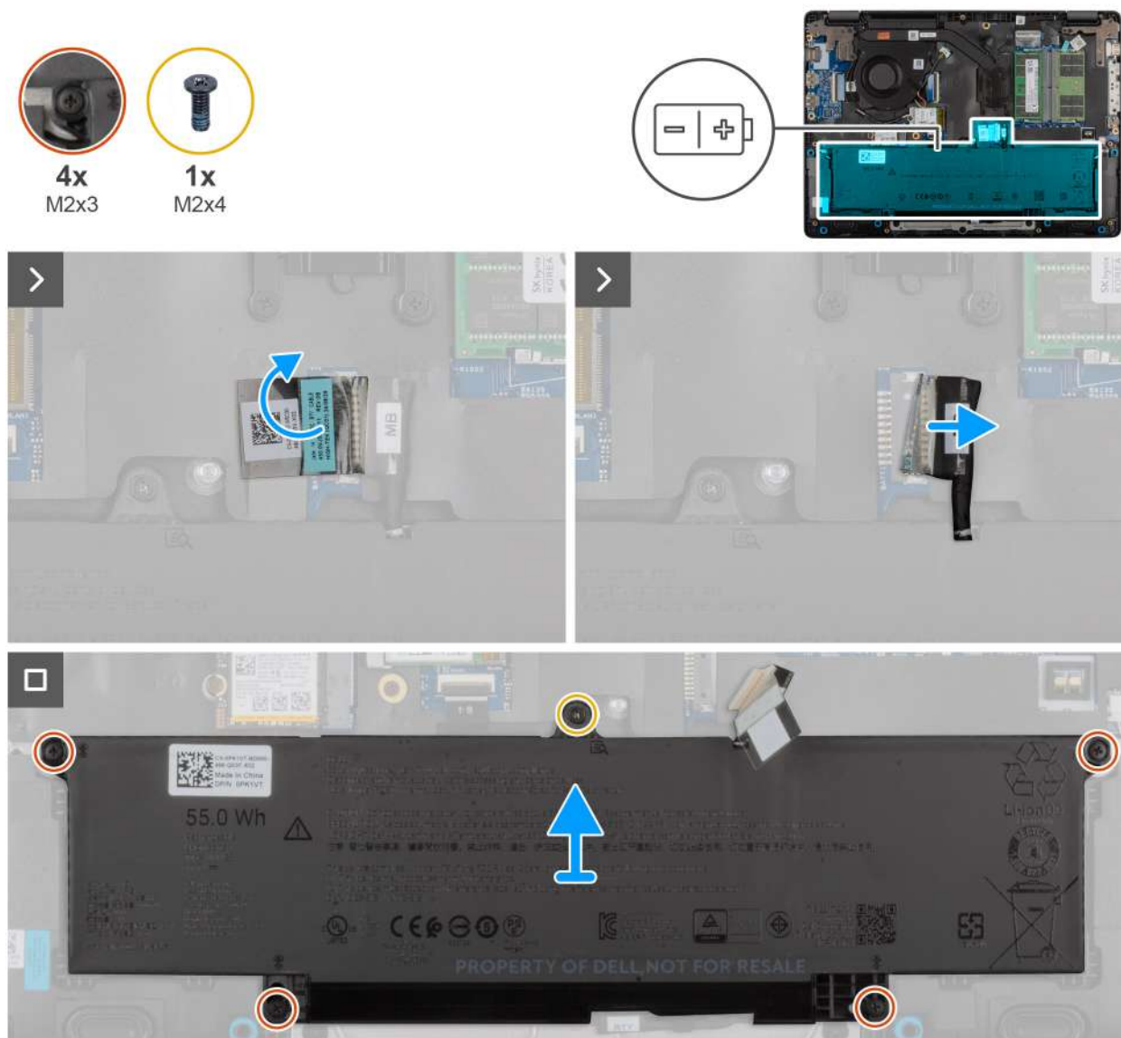
Ilustración 17. Extracción de la batería
