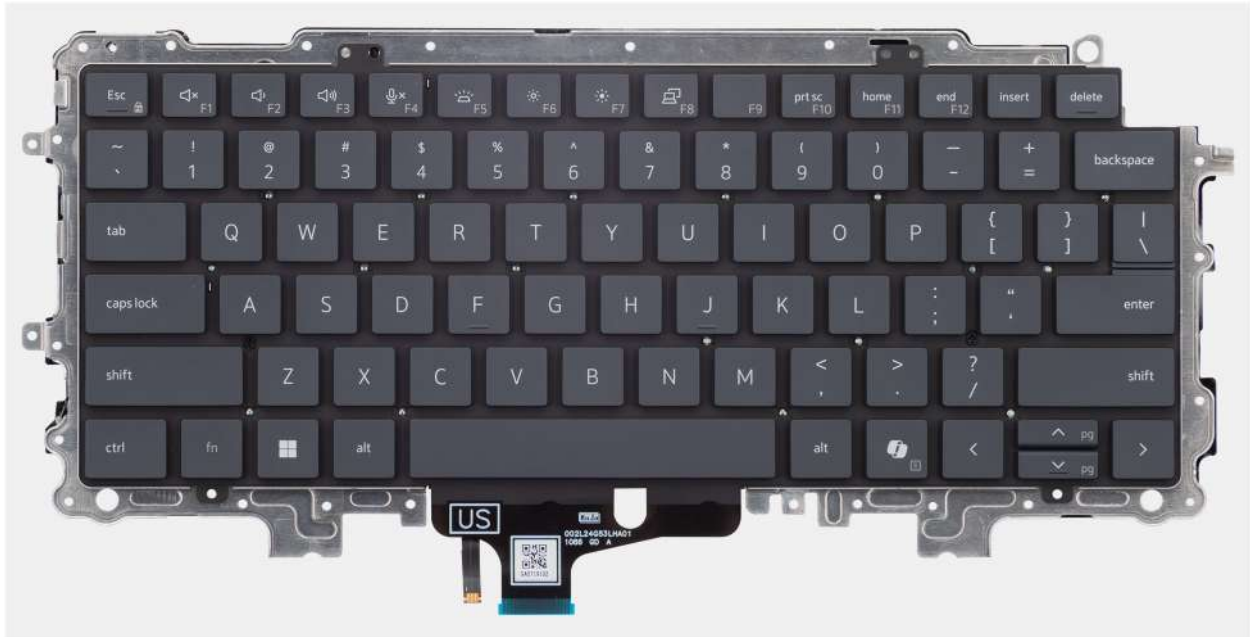
Ilustración 82. Instalación del teclado
