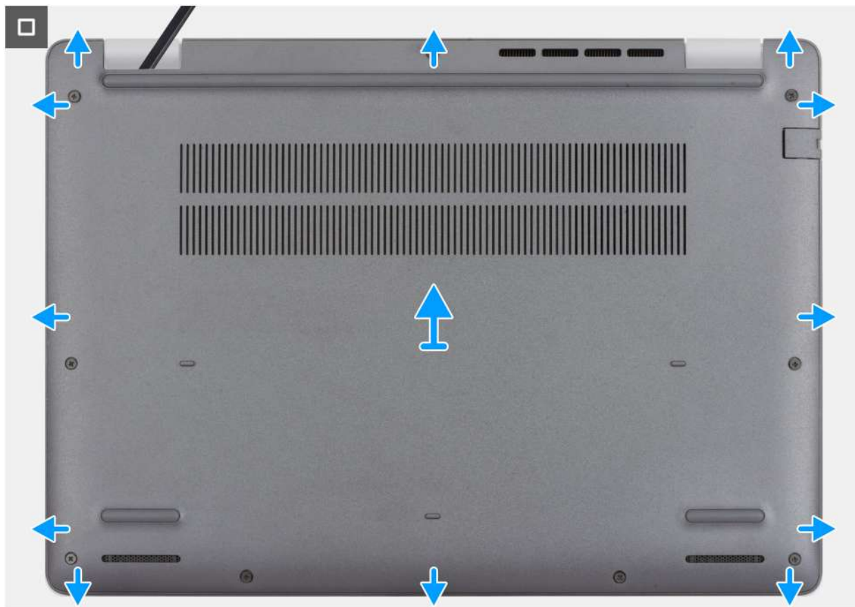
Ilustración 12. Extracción de la cubierta de la base
