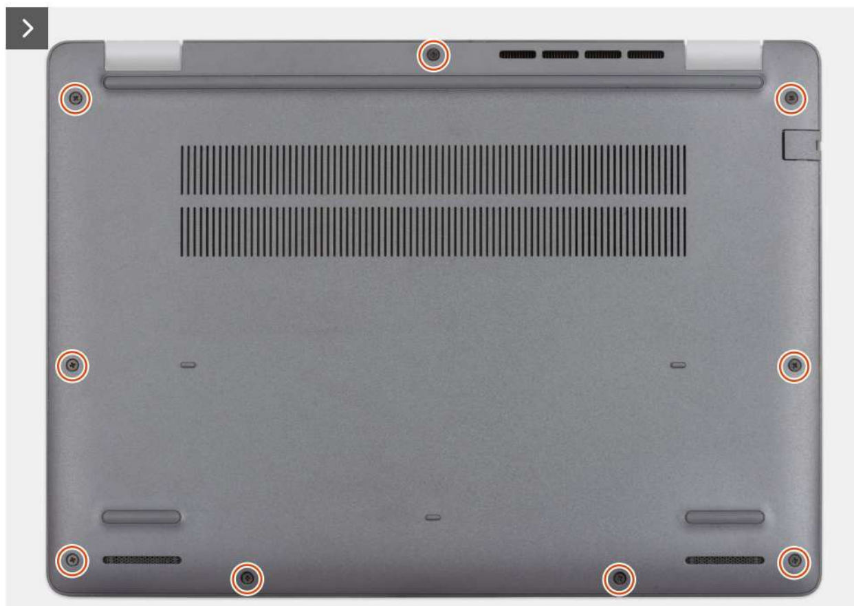
Ilustración 11. Extracción de la cubierta de la base
