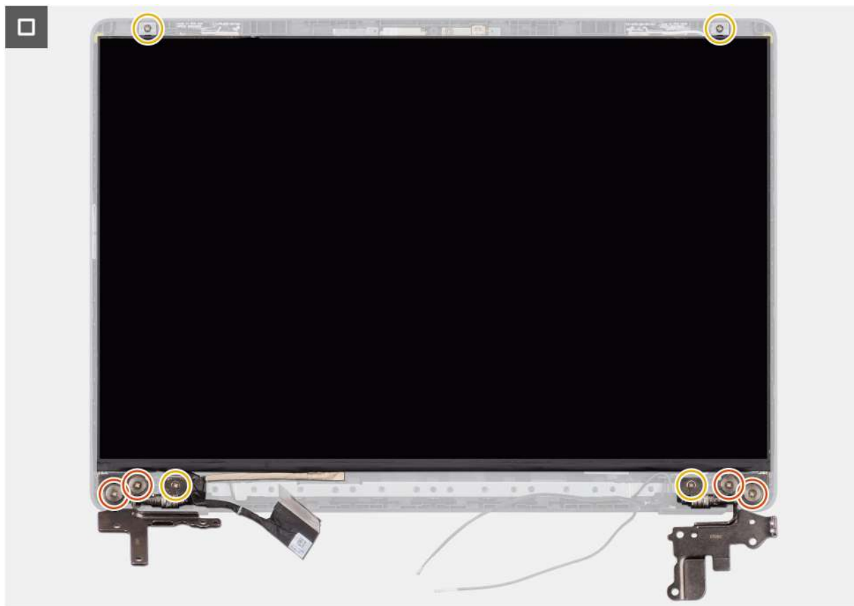
Ilustración 118. Instalación del ensamblaje del panel de pantalla
