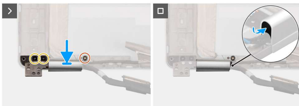
Ilustración 87. Instalación del cable de pantalla
