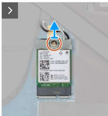
Ilustración 40. Extracción de la tarjeta WLAN
