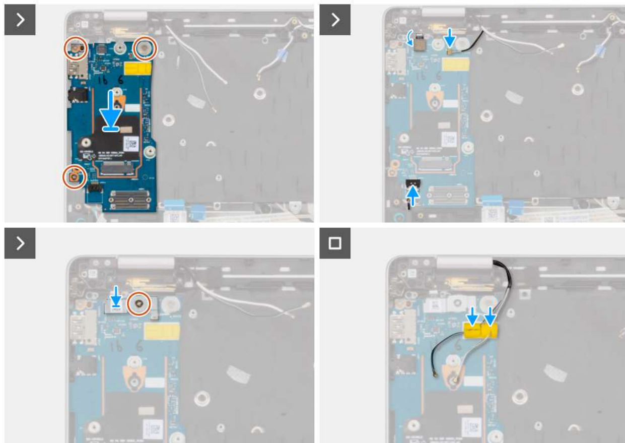
Ilustración 61. Instalación de la placa de I/O
