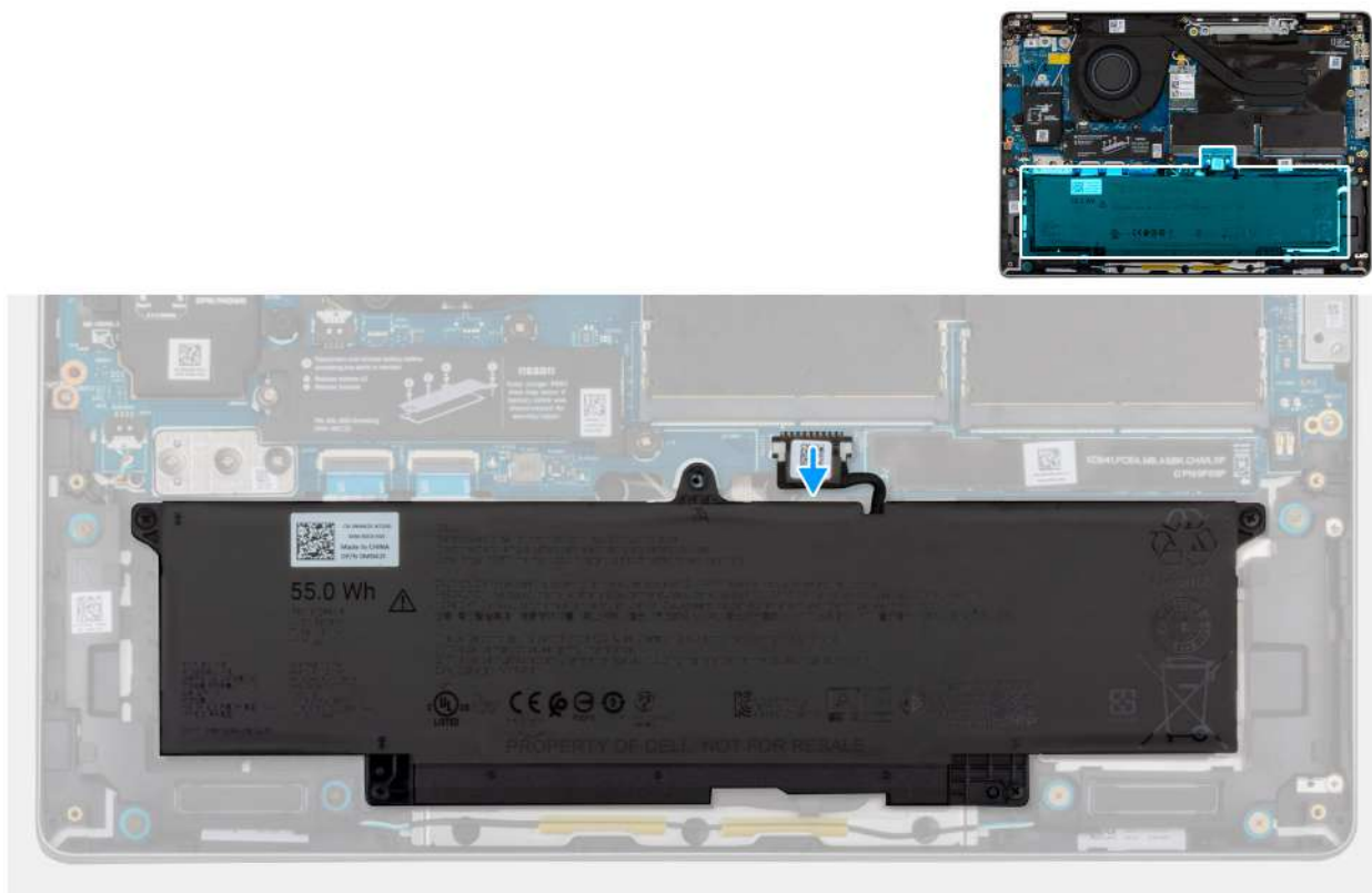
Ilustración 24. Desconexión del cable de la batería
