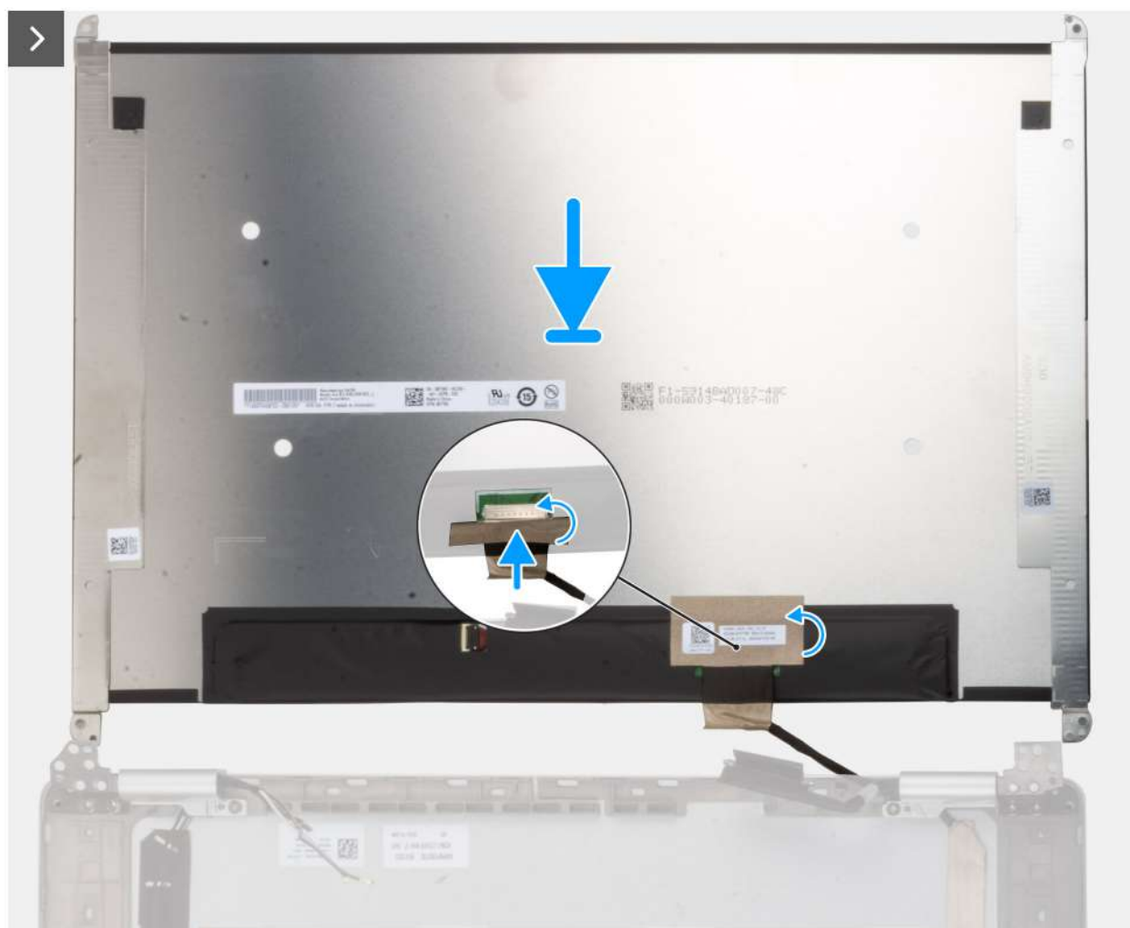
Ilustración 78. Instalación del panel de pantalla
