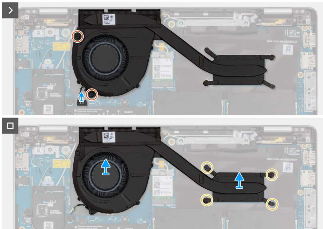
Ilustración 44. Extracción del ensamblaje del disipador de calor y el ventilador
