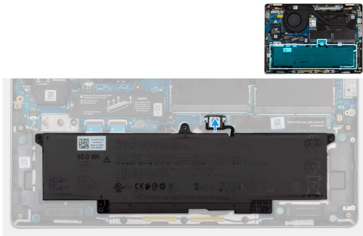
Ilustración 25. Conexión del cable de la batería
