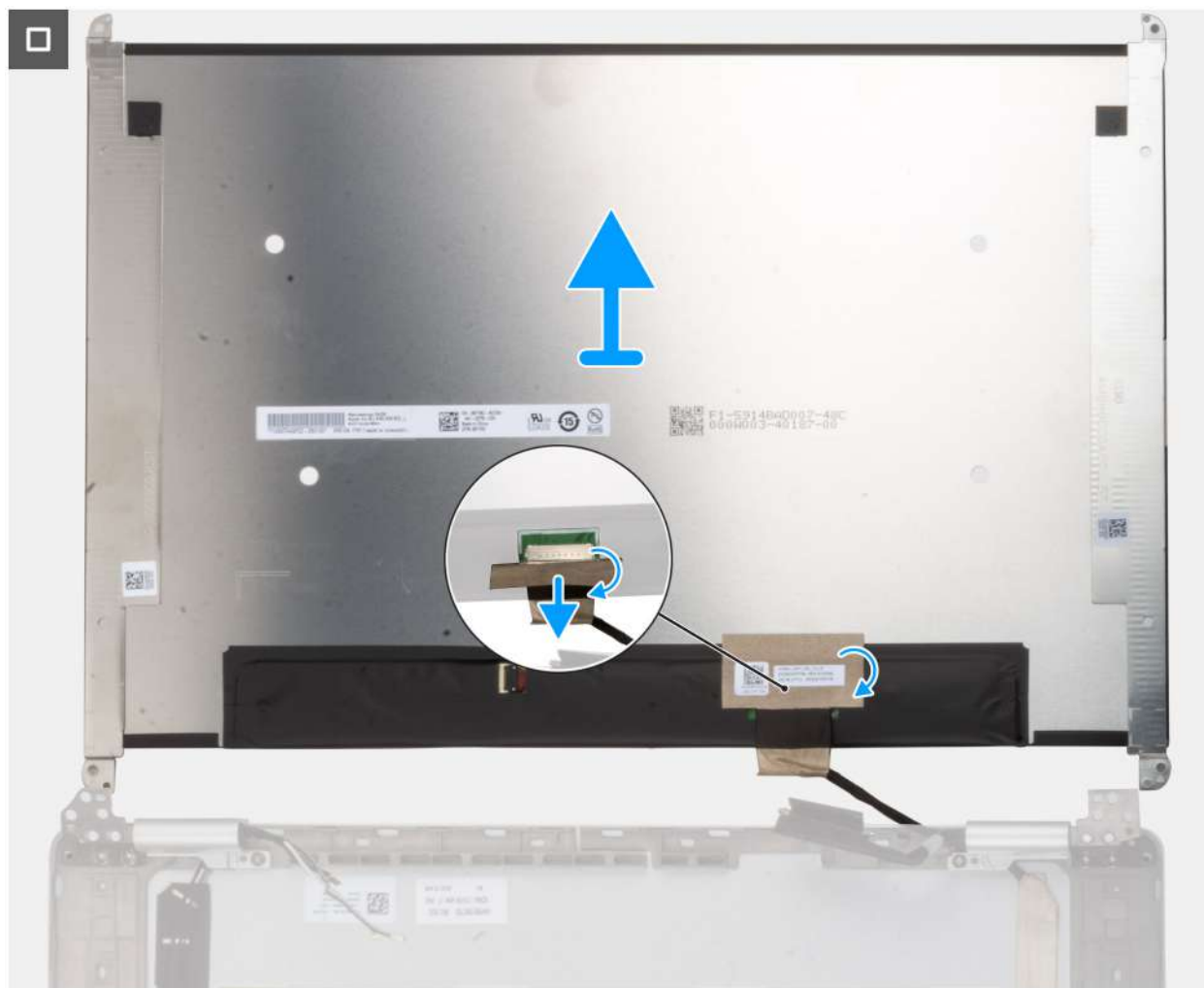
Ilustración 76. Extracción del panel de pantalla
