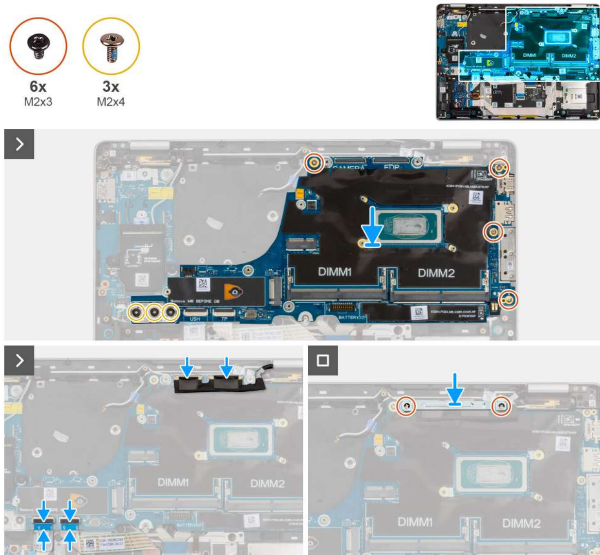
Ilustración 53. Instalación de la tarjeta madre
