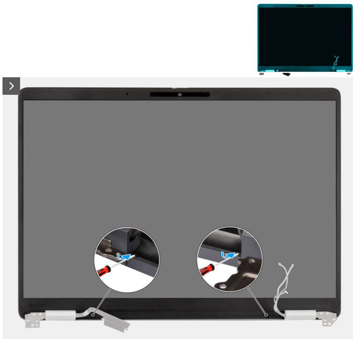
Ilustración 68. Extracción del embellecedor de la pantalla
