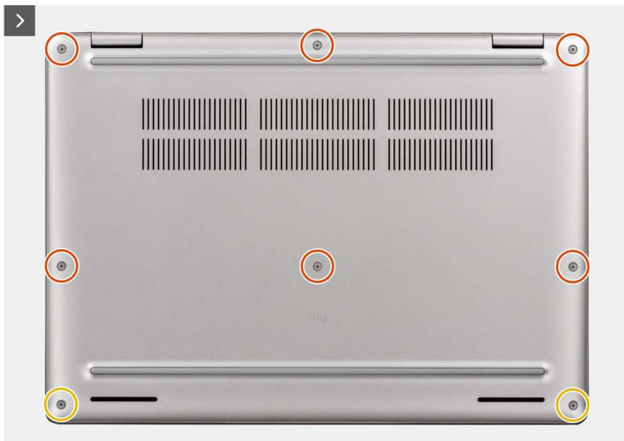
Ilustración 22. Extracción de la cubierta de la base
