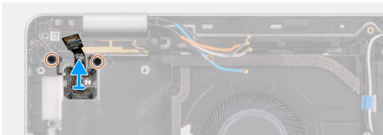
Ilustración 62. Extracción del botón de encendido con lector de huellas digitales opcional
