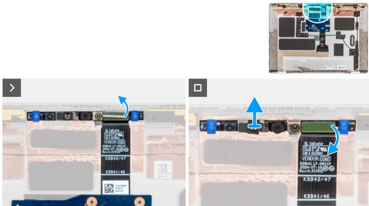
Ilustración 88. Extracción de la cámara MIPI
